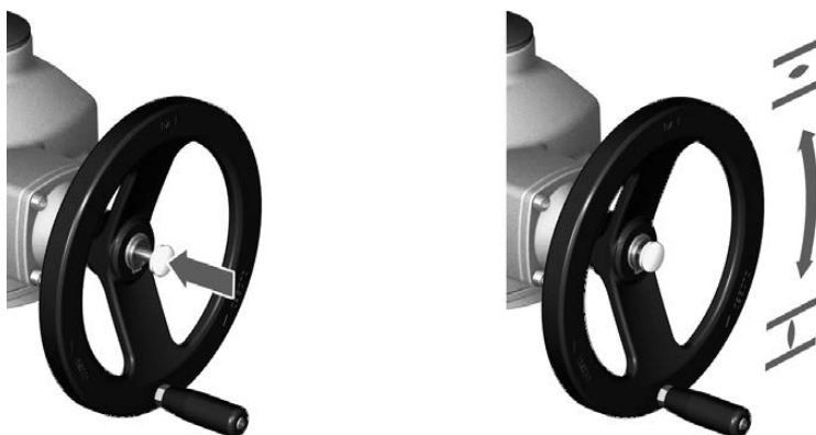
Figure 27 : Enclencher le fonctionnement manuel
