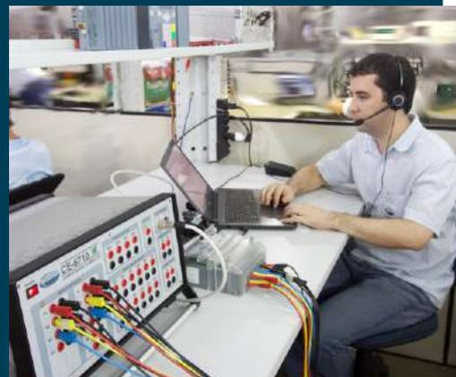
Potência suficiente para testes de relés em qualquer tecnologia (Eletromecânico, Estático e IED);
