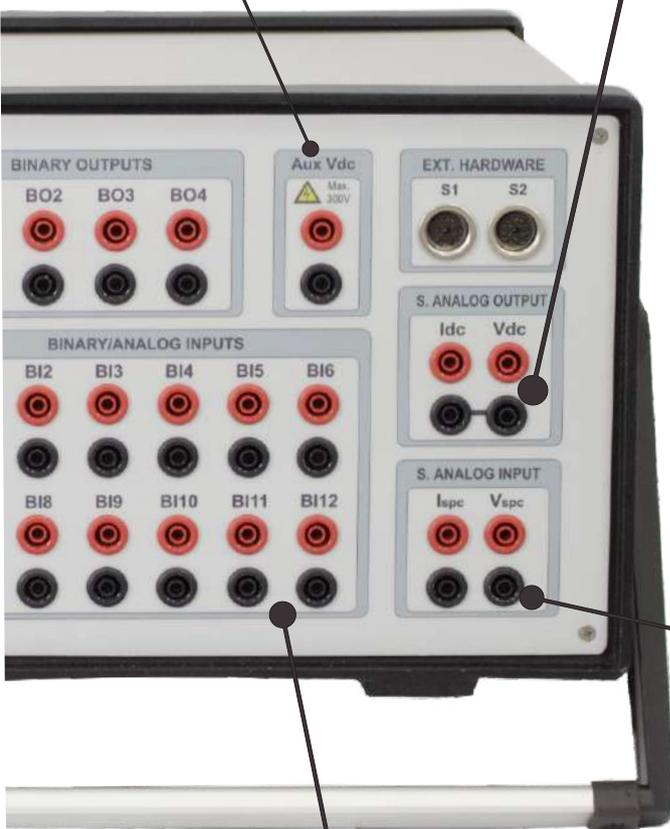
Entradas especiais analógicas de tensão e corrente específicas para testes em transdutores.
