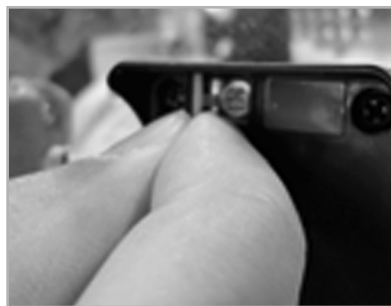
8) LED 창 일자면부터 기대어 놓고 밀어 넣는다. 이때 딸각 소리가 나는지 확인한다. (Please push the (-) type part of LED window in the make sure that if you hear "clack", it is perfectly assembled.)
