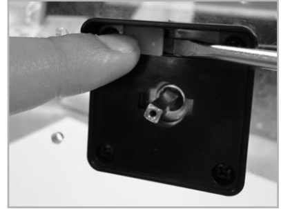
3) LED창 안쪽 홈으로 (-) 드라이버 이용 하여 들어올린다. 이때 LED창 분실 우려가 있으므로 LED창을 고정시킨다. (Lift it up with screwdriver (-) type, please be careful with LED window it may involve the risk of loss.)
