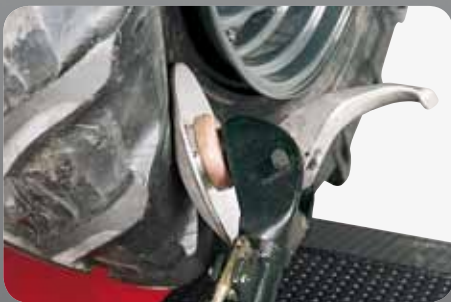
Fase di stallonatura pneumatico Pneumatic bead breaking Phase des Reifenabdrückens
