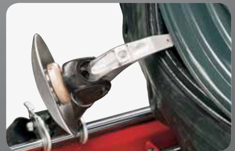
Fase di smontaggio pneumatico Demounting the tyre Phase der Reifendemontage
