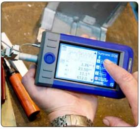
Lebensphasen des Produkts. Z. B. Überwachung von Veränderungen in der Schaufelrauigkeit, um Defekte und Effizienzverluste frühzeitig zu erkennen.
