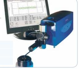
**Surtronic**<sup>®</sup> **R-80** ist ausreichend robust für die Anwendung im Produktionsbereich und zugleich präzise genug für den Einsatz im Messlabor. Eine flexible Lösung für jede Messung von Rundheit und Form.
